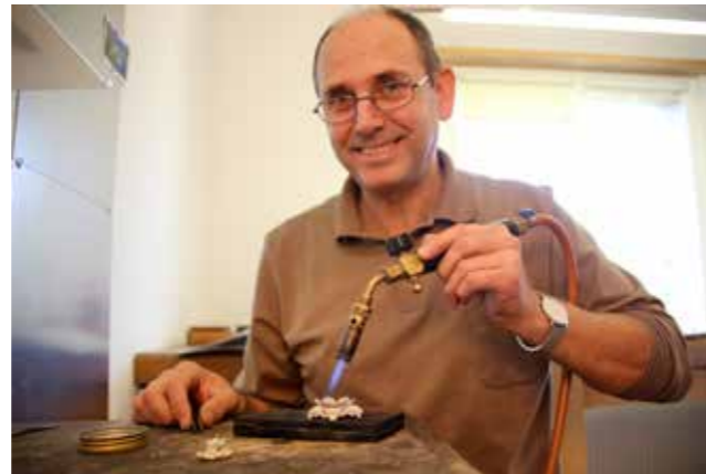
Gelötet wird auf einem Stück Kohle, da sie Wärme sehr gut speichert.
